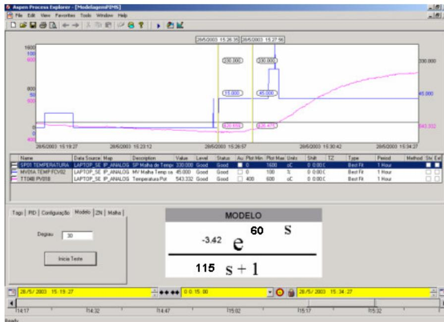
**Figura 8 – Estimação de parâmetros de um modelo FOPDT (Primeira ordem mais tempo morto) de uma malha de temperatura utilizando o PIMS**
