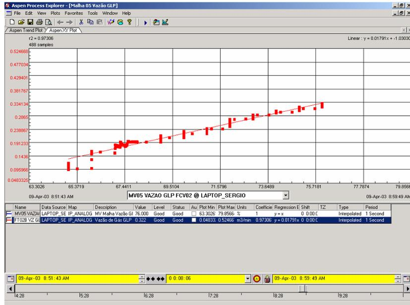
Figura 5 – Levantamento da curva da válvula (abertura x vazão) de controle de injeção de GLP em uma usina de beneficiamento de minério de ferro, utilizando o gráfico X-Y do PIMS
